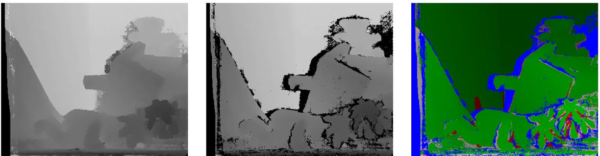
Abbildung 29: Disparitätskarten der Szene „Teddy“: Disparitätskarte aller Pixel und Disparitätskarte der als vertrauenswürdig eingestuften Pixel und Differenz zur „Ground Truth“; zur Farbcodierung siehe Abb. 28.
